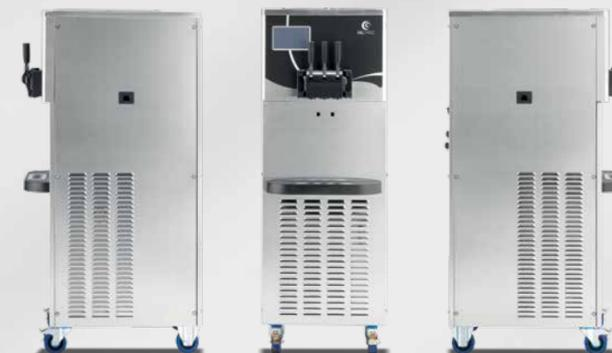
**Bigusto verticale (un compressore)** Questi modelli sono dotati di 4 circuiti frigoriferi indipendenti, alimentati da un unico compressore, per la gestione delle vasche e dei cilindri. Sono facili da posizionare grazie alle ruote girevoli con freno e si contraddistinguono per le dimensioni ridotte e la compattezza.
