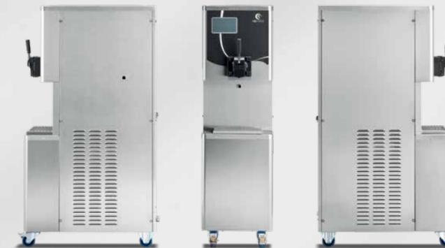
**Monogusto verticale** Con cilindri da 2,6 o da 3,5 litri, per rispondere a diversi fabbisogni, queste macchine sono facili da posizionare grazie alle ruote girevoli con freno. Possono essere controllate tramite In.Co.Di.S. o CKC e avere alimentazione monofase (compressori ermetici Bristol), oppure trifase (compressori semiermetici Dorin).
